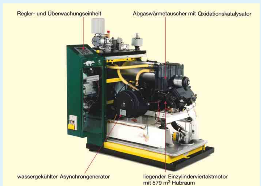
11 Mini-Blockheizkraftwerk mit Einzylinder-Viertaktmotor für den Betrieb mit Heizöl, Biodiesel oder Gas
