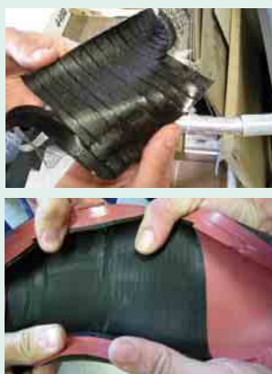
2 An der defekten Muffe sind Spuren von Teilentladungen zu erkennen
