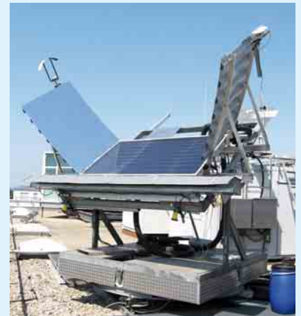
3 Flachkollektor mit Reflektoren
