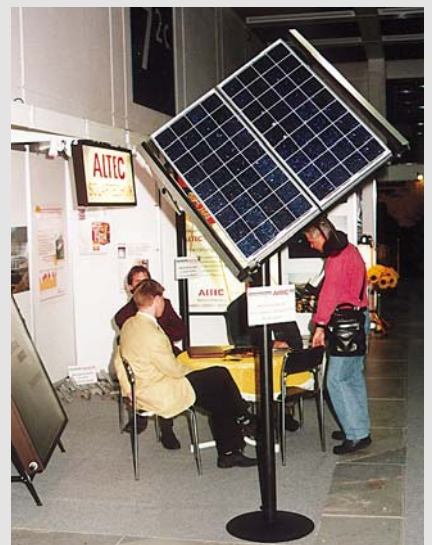
6 Teil eines Nachführsystems für Solargeratoren bis 6 m 2 Fläche. Die thermopneumatischen Elemente zur Bewegung sind in den äußeren Rahmen integriert.
