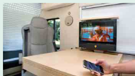
❸ Wird der TV-Modus aktiviert, fährt der Bildschirm hoch, die Sat-Anlage richtet sich aus und die Rollos schließen sich bei Bedarf
