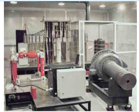
1 Blitzstromtest im Stoßstromlabor an einem nicht rotierenden Lager
