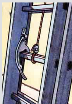
1 Schiebeleiter – zu achten ist besonders auf freie Beweglichkeit und das Einrasten der Feststelleinrichtungen
