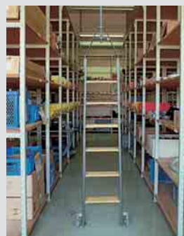
2 Rolleiter – verschiebbar in den Gängen um beide Regale zu erreichen
