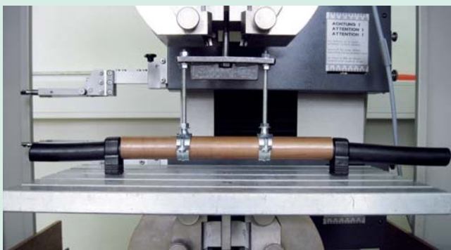
3 Belastungsprüfung der Befestigungsschellen
