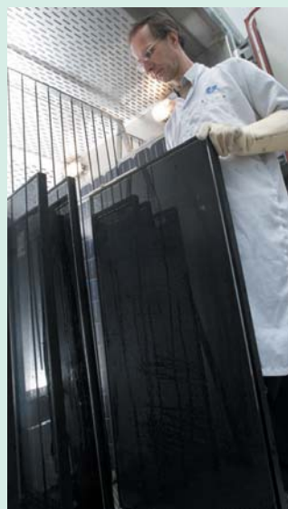
2 Dünnschicht-Solarmodule in der Klimakammer
