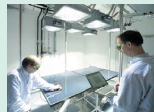
4 Lichttisch zur optischen und thermischen Vorbehandlung von Modulen
