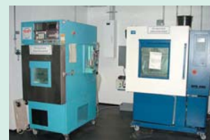
3 Klimaschränke für Klimatests und beschleunigte Alterungstests
