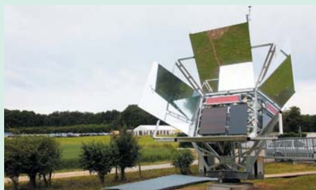
5 Zweiachsig nachgeführter Solar-Tracker mit vier großen Spiegeln auf dem Testfeld Widderstall
