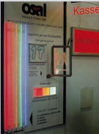
⑤ Aus Lichtleisten mit farbigen LED und speziellen Acryl-Glas-Scheiben lassen sich Leuchtschilder mit großer Farb- und Gestaltungsvielfalt aufbauen (Osai und BWF)
