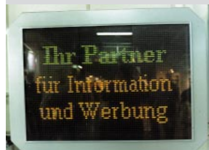
3 Durch ihre Helligkeit und klare Struktur lassen LED-Displays störende Reflexionen aus dem nahen umgebenden Raum zurücktreten
