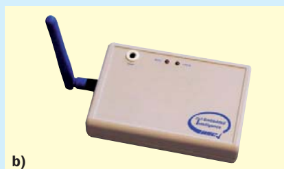
2 Über Empfangs-/Sendemodule erfolgt die Anbindung der Sensoren und Aktoren
