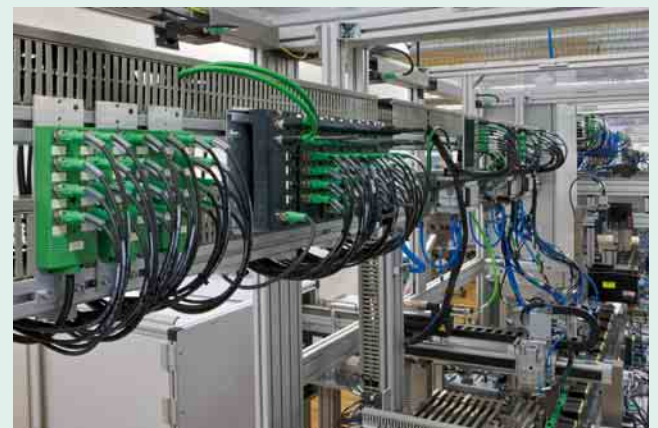
1 Komponenten der Systemverkabelung weisen hohe Schutzarten auf und trotzen Ölen, Wasser oder Stäuben
