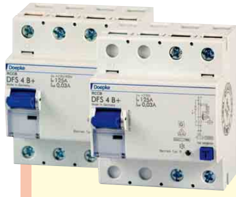
8 Die Baureihe des Typs B+ eignet sich besonders für Anlagen mit Betriebsmitteln, die Leistungselektronik enthalten und ohne galvanische Netztrennung arbeiten
