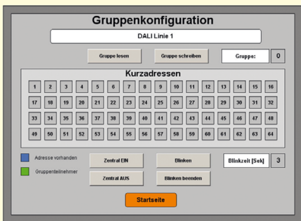
❸ Web-Konfigurationsmaske zur Festlegung von DALI-Beleuchtungsgruppen
