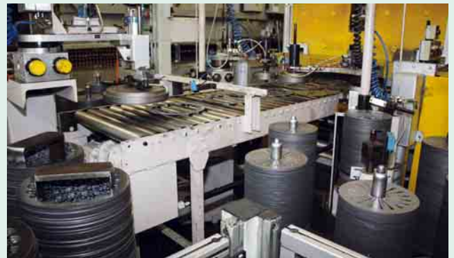
1 In der Härterei: Elektro-Magnete setzen Metallteile auf ein Rollenband
