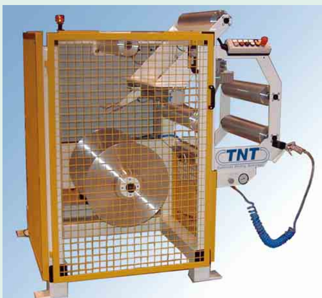
② Der Randstreifenwickler ist mitsamt der Haspel an einem stabilen, bodenverankerten Gestell befestigt, um mögliche Unwuchten auszugleichen
