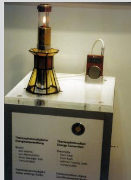
1 Thermophotovoltaik wandelt Wärmestrahlung in Strom – eine Flamme liefert die infrarote Wärmestrahlung, die eine Solarzelle in Strom zum Betrieb eines Radios wandelt
