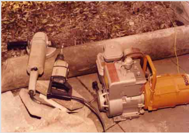
④ Tragbarer Ersatzstromerzeuger auf abgelegenen Kleinbaustellen
