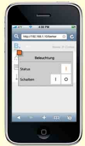
1 IP-Control Mobile kann einfach per Browser am mobilen Endgerät aufgerufen werden, um auf KNX/EIB-Komponenten der Gebäudeautomation zuzugreifen
