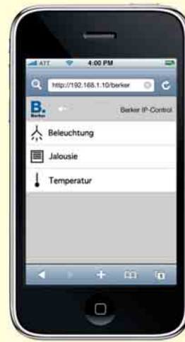
1 IP-Control Mobile kann einfach per Browser am mobilen Endgerät aufgerufen werden, um auf KNX/EIB-Komponenten der Gebäudeautomation zuzugreifen
