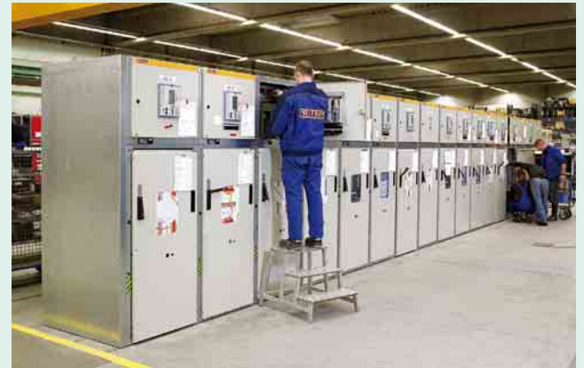
2 Die GT4-Schaltfelder ermöglichen eine kompakte Lösung für Schaltaufgaben bis zu einer Spannung von 24 kV
