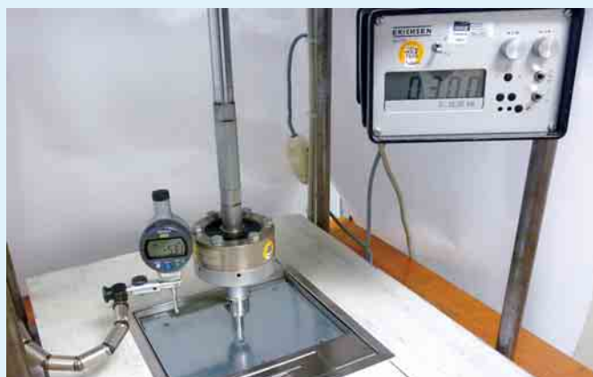
❷ Belastungsprüfung eines Geräteinsatzes Metall mit 3 kN und einer zulässigen Durchbiegung von weniger als 6 mm
