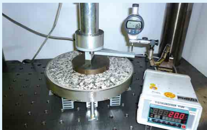
❶ Belastungsprüfung einer Schwerlastkassette mit 20 kN
