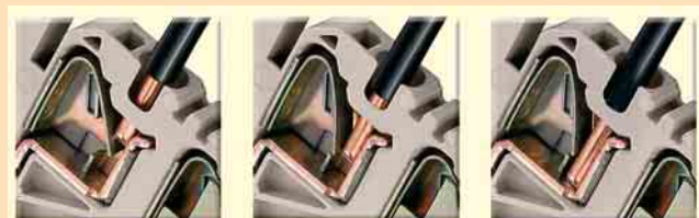
1a Beispiel für Zugfederklemme der Verbindungsdose PV 48 für die Photovoltaik
