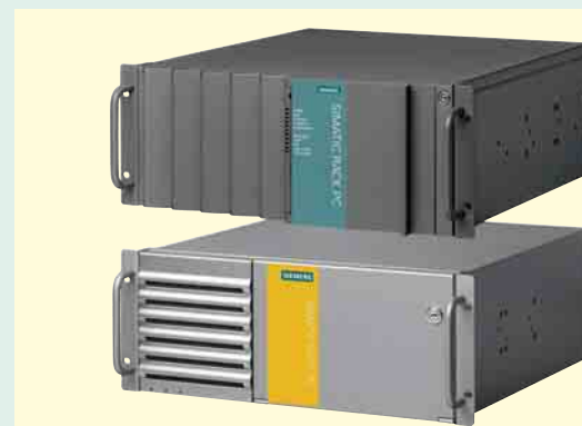
1 Die Simatic Rack PC bieten PCI-Express-Steckplätze und „Raid onboard“ für datenintensive Anwendungen, wie etwa die schnelle Bilderfassung mit Framegrabberkarten
