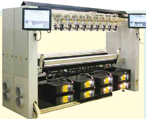
③ Skalierbares Websight-System von Basler zur optischen Qualitätskontrolle von Endlosware: Prüfeinheit und abgesetzte Bedienstation ermöglichen die flexible Anpassung an vorhandene Fertigungslinien
