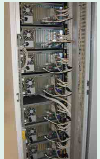
2 Vorder- und Rückseite des Websight-Systems mit neun Rack PC 847B
