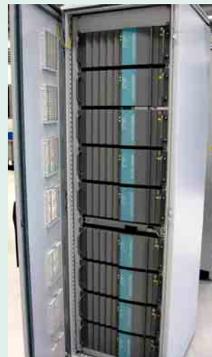
2 Vorder- und Rückseite des Websight-Systems mit neun Rack PC 847B
