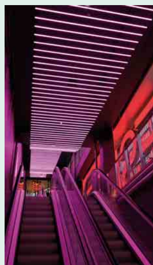
2 Folgt den drei Rolltreppen in ihrem Lauf: die auch von außen sichtbare LED-Lichtwelle mit verschiedenen Lichtszenarien wie z. B. rechts oranges Licht, das sich auf gelbem Grundlicht bewegt, für den Sommer
