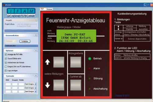
3 Visualisierung des Feuerwehr-Anzeigetableaus mit der Software PCFAT Quelle: IFAM
