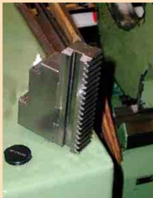
② Spannbacke, die weggeschleudert wurde ▶
