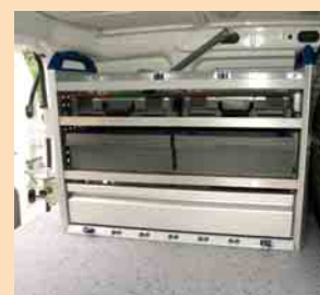
3b Innen Sortimo-Globelyst-Ausstattung für Werkzeug und Kleinteile
