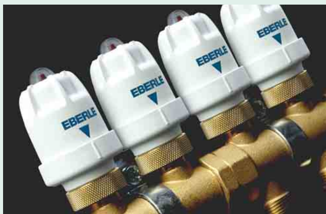
1 Mit dem Hubmaß von 4,5 mm und dem Anschlussmaß M 30 x 1,5 mm kann auf den Einsatz von Adaptern verzichtet werden, da der Stellantrieb damit auf eine Vielzahl von Ventilen und Verteilern problemlos aufgeschraubt werden kann. Auch eine Überkopfmontage ist möglich
