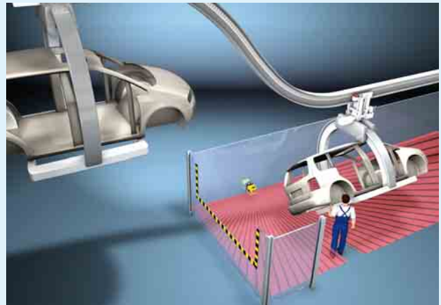
4 Anwendungsszenario einer AOPDDR mit einem Sicherheits-Laserscanner und Darstellung des Schutzfeldes
