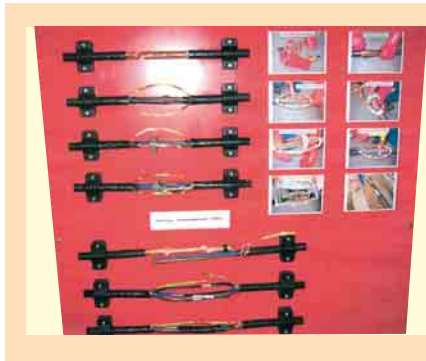
➊ Arbeitsschritte für das Setzen einer Verbindungs-muffe
