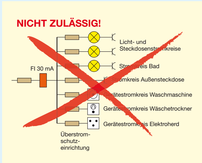
12 Beispiel für ein nicht normgerechtes und somit gefährliches Installationskonzept
