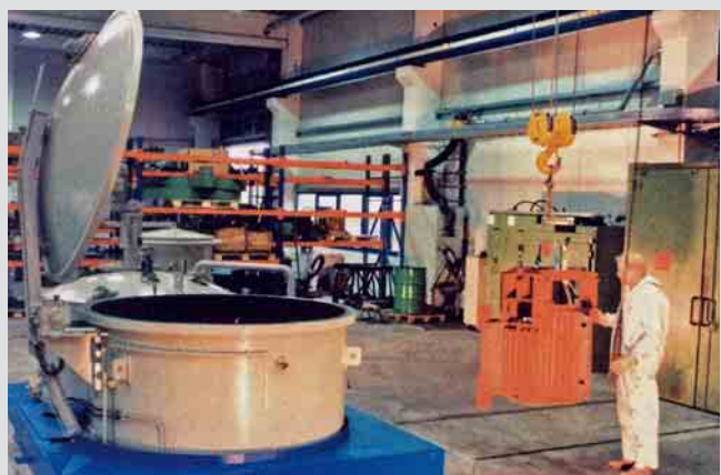
❷ Arbeitsraum in einem Betrieb für Elektromaschinenbau mit Arbeitsplatz an einer Vakuumtränkanlage
