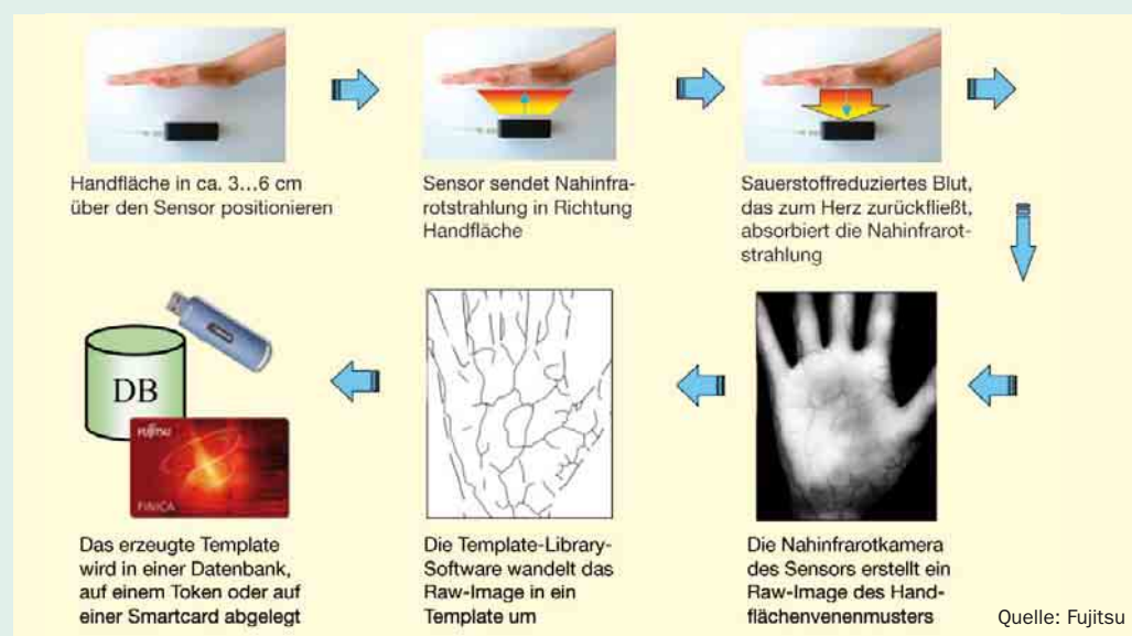
2 Funktionsweise der Handvenenerkennung und Umwandlung in eine Vorlage (Template)
