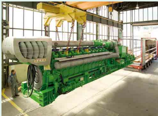
③ Für den Tomatenzüchter Royal Pride sind die beiden 24-Zylinder-Gasmotoren nicht die ersten Aggregate von Jenbacher. Die neuen Maschinen – hier bei der Verladung – ergänzen neun bereits installierte 3-MW-Anlagen
