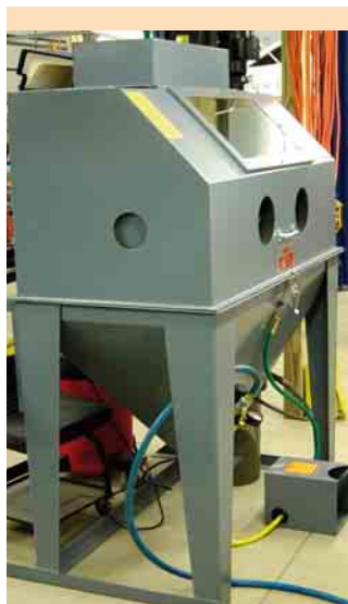
1 Sandstrahlkabine zur Oberflächenvorbehandlung
