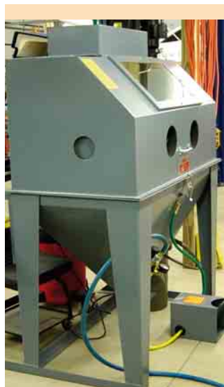
1 Sandstrahlkabine zur Oberflächenvorbehandlung
