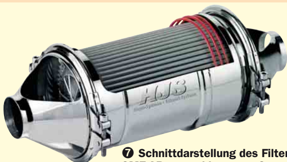
6 Dieser Partikelfilter arbeitet mit offenem System
