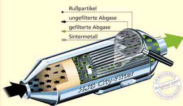
6 Dieser Partikelfilter arbeitet mit offenem System
