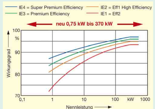
1 Entwurf der neuen Motoren-Effizienzklassifizierung nach IEC 60034-30 – Wirkungsgrade in den verschiedenen Energieeffizienzklassen und Nennleistungsbereichen
