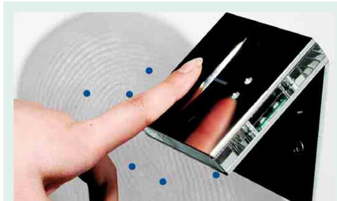
1 Sensoreinheit des Finger-Identifikations-Systems erfasst nur die Minutien eines Fingers
