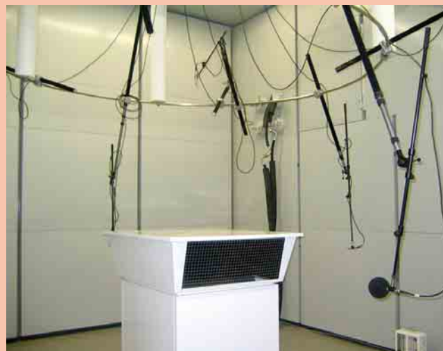
1 Ermittlung des Schalleistungspegels in einem reflexionsarmen Halbraum
