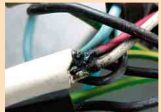
5 Abisolierfehler – Kriechstrombildung als Folge
