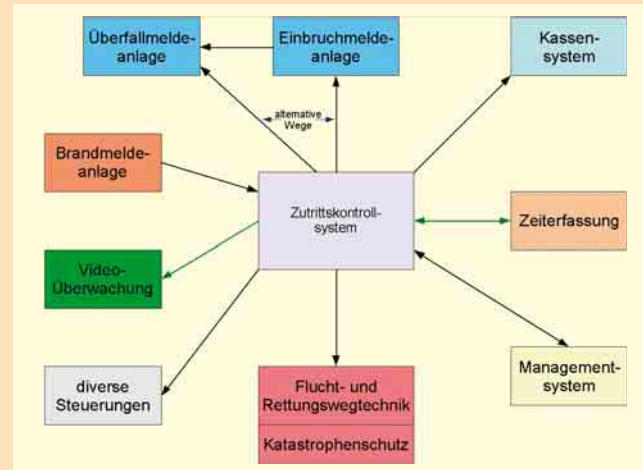
ZKS als zentrales System eines sicherheitstechnischen Systemverbundes
