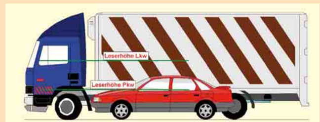
2 Einsatz von Weitbereichslesern für unterschiedliche Höhen
