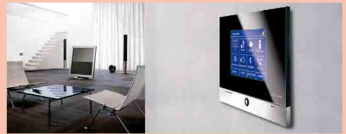
1 Ein Beispiel für das Vernetzen innovativer Technik: Das mit einer speziellen Schnittstelle ausgestattete Busch-Jaeger-Raum- und Controlpanel verbindet die verschiedenen Komponenten der Bang&Olufsen-Unterhaltungselektronik mit der Gebäudesystemtechnik Foto: Busch-Jaeger
