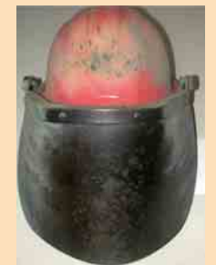
9b Helm-Visier-Kombination nach Klasse-2-Test
