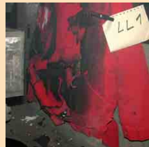
7 Beispiel einer bestandenen Lichtbogen-Klasse-2-Prüfung eines Latexhandschuhs
