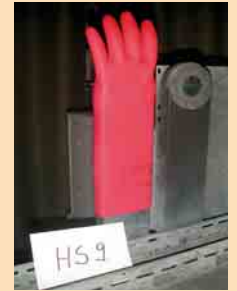
8 Probenhalterungen für den Box-Test an Schutzhandschuhen mit Kalorimetern
