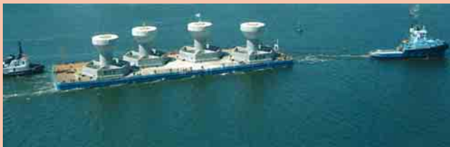
③ Transport von Schwerkraft-Fundamenten
