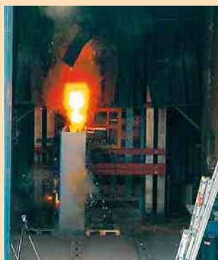
④ Störlichtbogenversuch im IPH-Prüffeld mit 65 kA, 300 ms – bestanden mit Moducon
