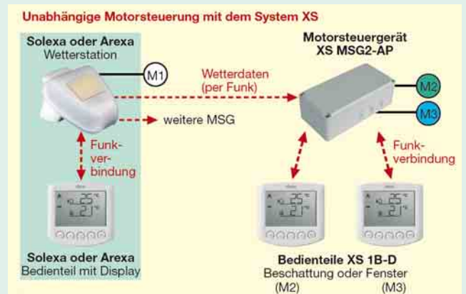
3 Beispiel für eine unabhängige Funk-Steuerung: Für alle Motoren lassen sich unterschiedliche Automatikbefehle einstellen. Es können Beschattungs- und Fenstermotoren angeschlossen werden
