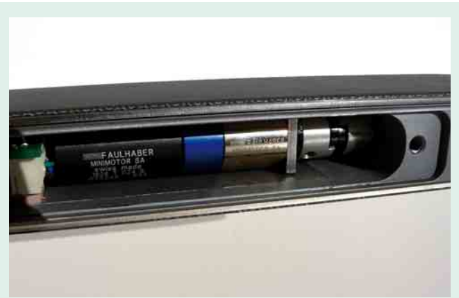
3 Integrierter 16-mm-EC-Kleinstantrieb mit zugehörigem Getriebe in einem Standard-Förderband
