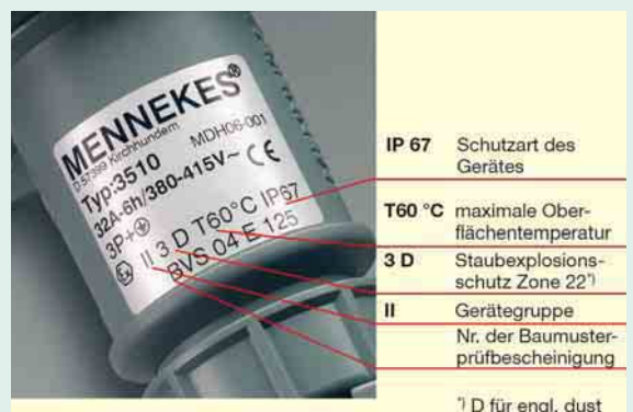
1 Steckvorrichtung in einem Bereich, in dem brennbare Staub-/Luftgemische entstehen können Foto: Mennekes
