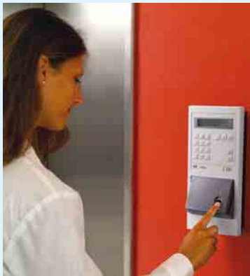
4a Zutrittskontrolle mit Fingerprint
